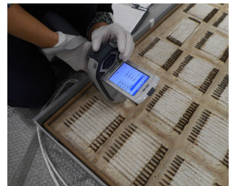
蛍光X線分析装置を使用しているところ
